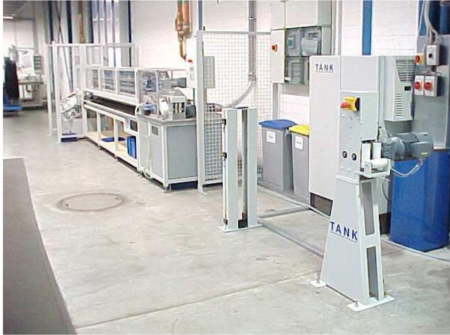
Frequenzgeregelter Riementransport zum Abhaspeln der Schläuche von der Schlauchtrommel, gesteuert über die Transportgeschwindigkeit der Hauptmaschine und einer Abschaltung des Antriebs über Lichtschranken
